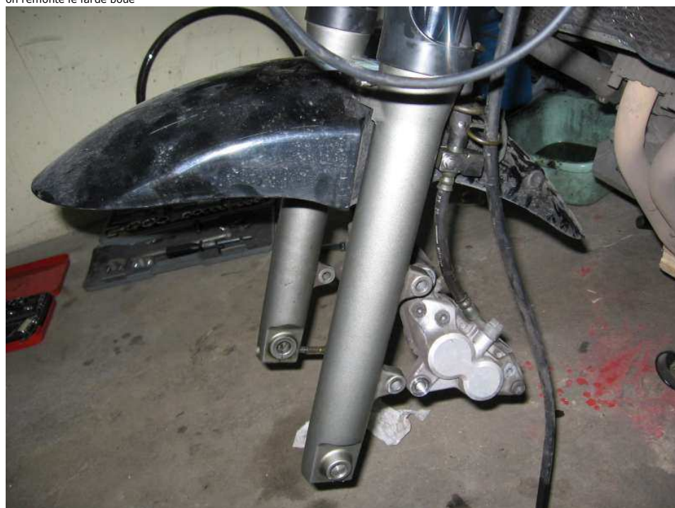
au moment de remonter la roue on fait attention a l'ergot du branchement du compteur de vitesse
